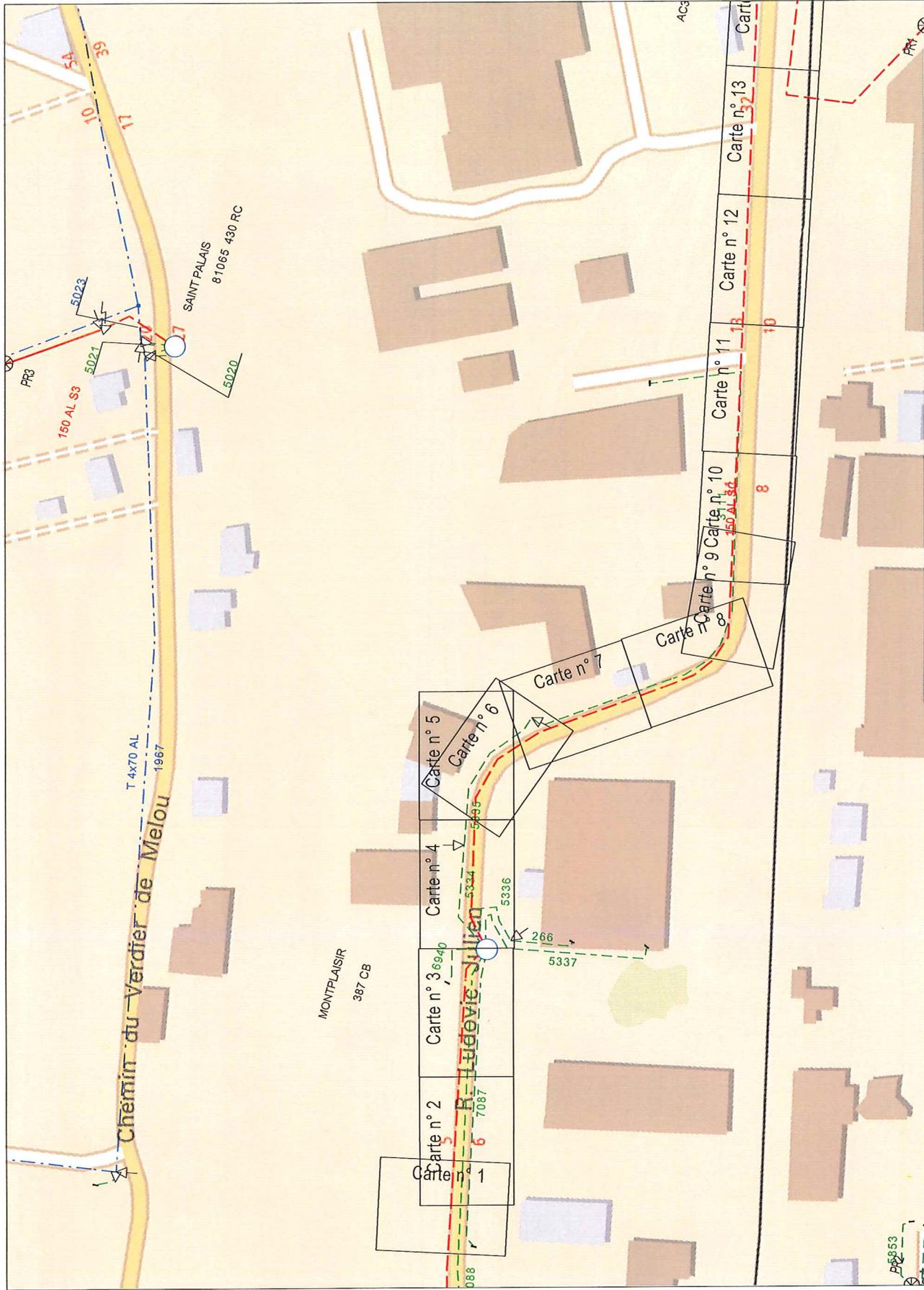
2- A titre indicatif et sans mention expresse, les ouvrages souterrains ont été construits à une profondeur moyenne de 0,50 m sous trottoir ou accotement et de 0,85 m sous chaussée. Toutefois, des contraintes de construction et des opérations éventuelles de déblaiement ou de remplacement pourraient modifier la pose de l'ouvrage, soit par modification de la profondeur, soit par un ouvrage construit selon ces règles.
